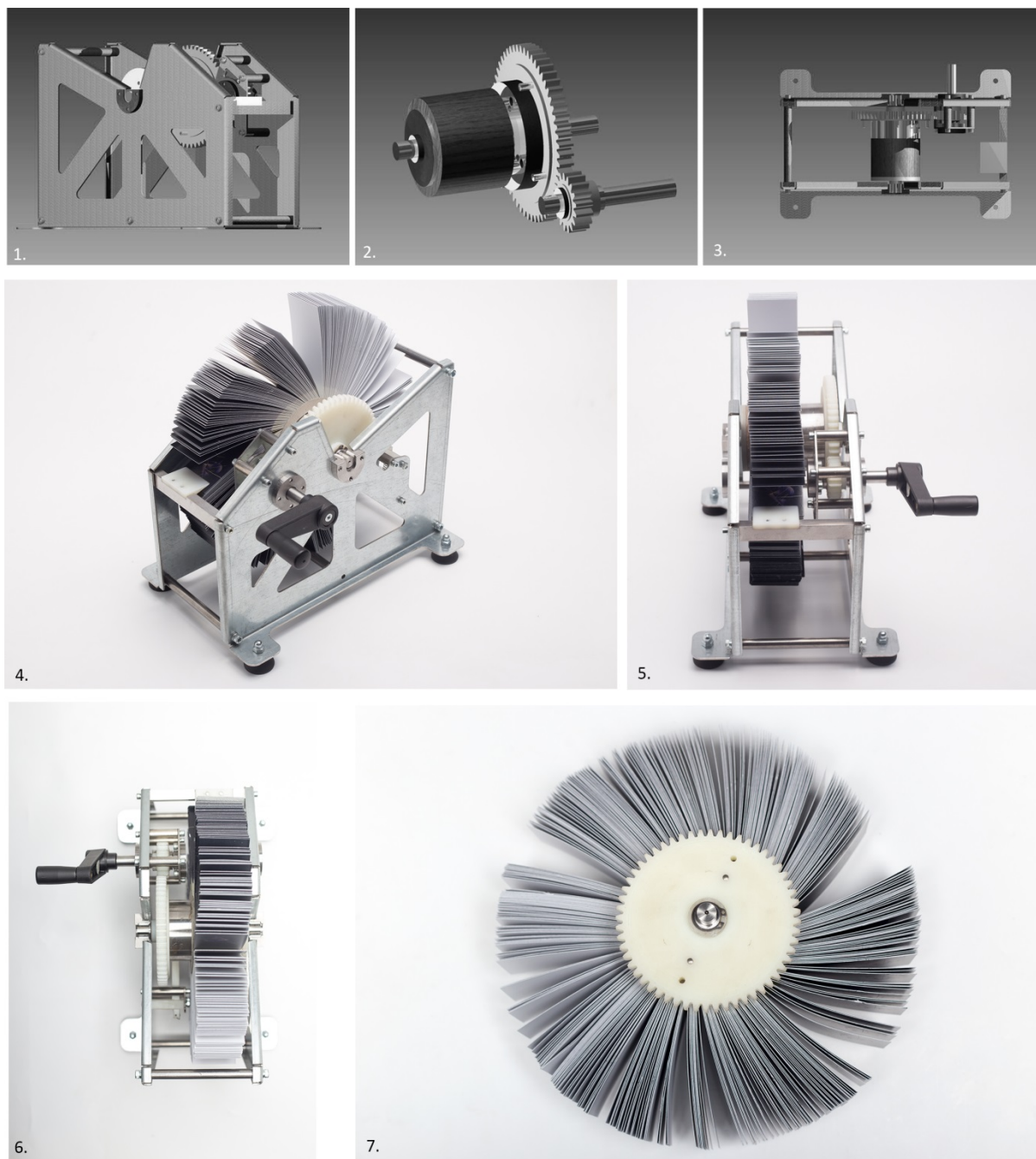
Rysunek 5. 1.2.3- Projekt Mutoskopu, wykonał. Wojciech Wujkowski, materiały własne, 4.5.6.7- detal mechanizmu Mutoskopu. zdj. Mirosław Niesyto, materiały własne
